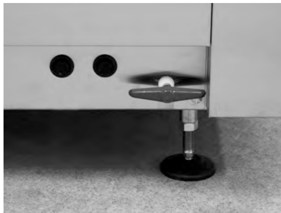
obraz 22 Dostęp do zabezpieczeń przed przegrzaniem
