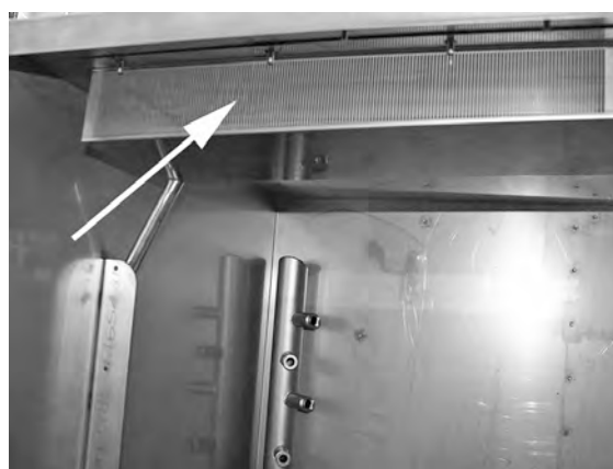
obraz 41 EcoExchanger widoczny wewnątrz kabiny urządzenia.
