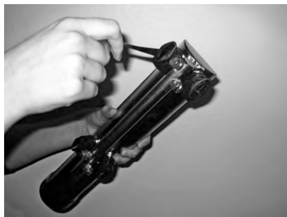
Imagen 24 Limpieza de las boquillas de lavado
