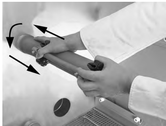
Imagen 23 Retirada del tubo de rociado
