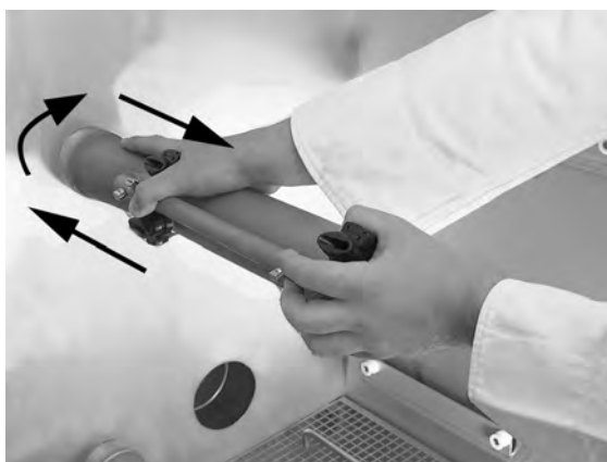
Imagen 30 Recolocación del tubo de rociado
