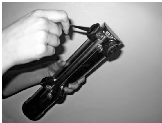
Imagine 24 Curățarea duzelor de spălare
