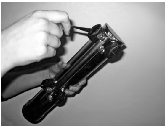
Photo 24 Nettoyage des buses
