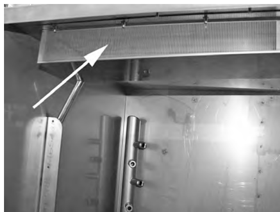
Bild 41 EcoExchanger som den ser ut inuti diskmaskinskabinen
