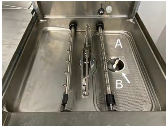
Abbildung 21 Herausnehmen von Tankgitter und Filter
