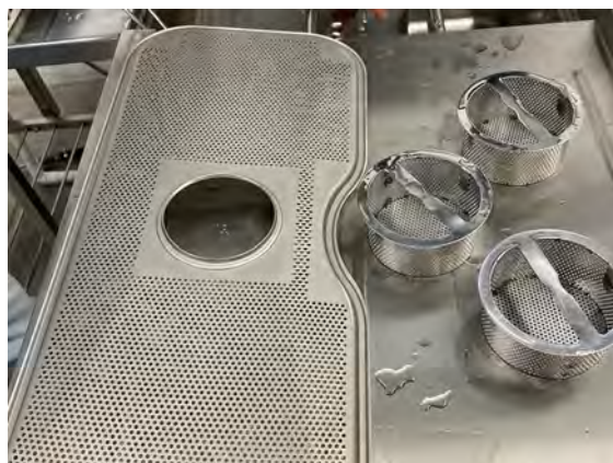
Abbildung 23 Reinigung der Filter und des Tankgitters
