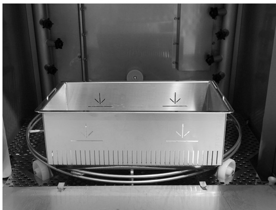
Imagen 30 Colector de gránulos en la máquina
