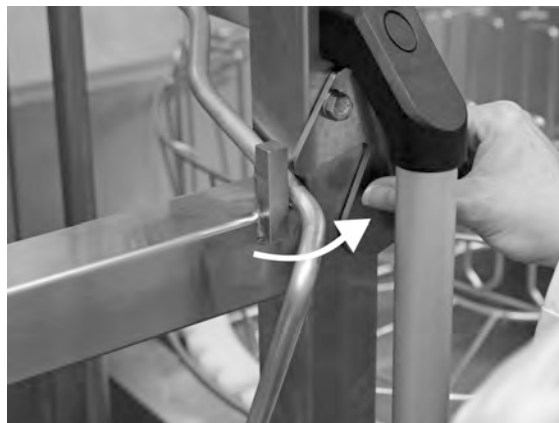
Figure 8 Затварящ механизъм на контактната ролка
