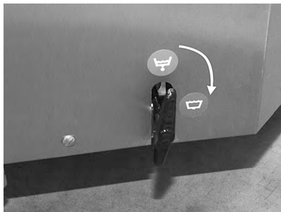
Figure 4 Кран за източване
