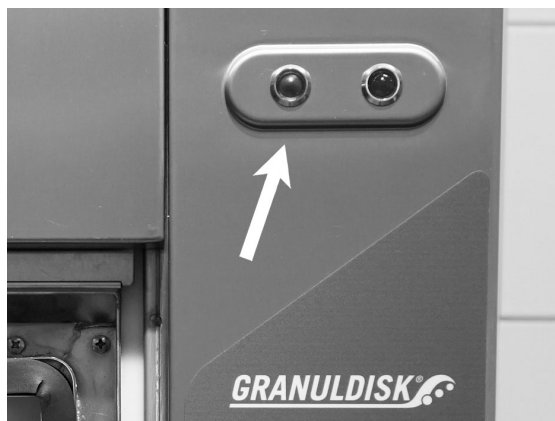
εικόνα 21 Όταν το πρόγραμμα ολοκληρωθεί, ανάβει το πράσινο φως.
