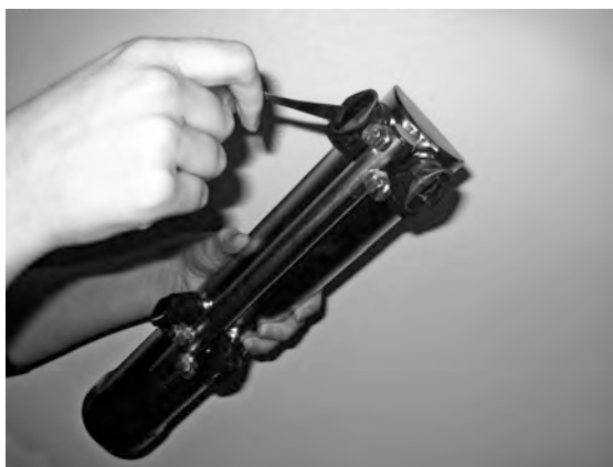
εικόνα 24 Καθαρισμός ακροφυσίων πλυσίματος
