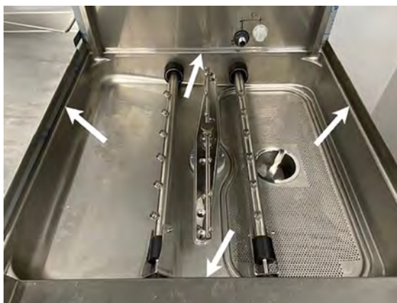
Bilde 24 Tørke av kantene av tanken
