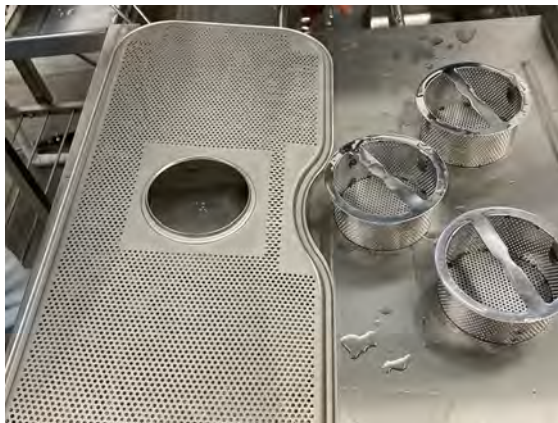
Billede 23 Rengør filtre og tankriste
