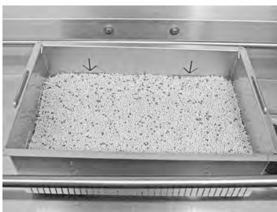
Obrázek 22 Kontrola hladiny granulí
