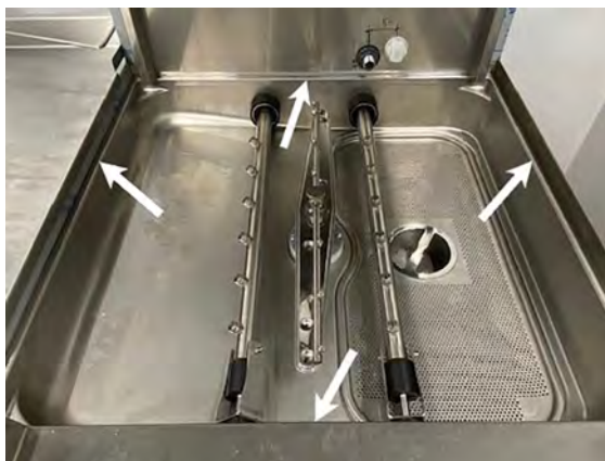
Figure 24 Избърсване по ръбовете на резервоара
