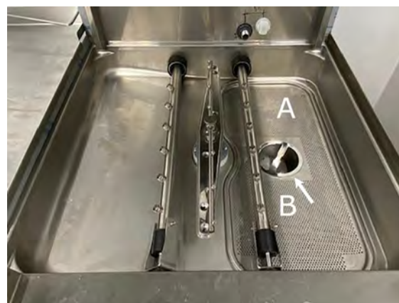
Figure 21 Отстраняване на решетката на резервоара и филтъра
