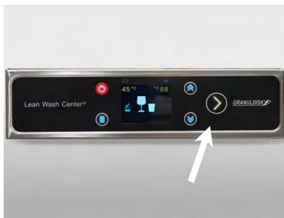
obraz 3 Napełnianie wodą
