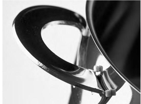
Abbildung 19 Kontrollieren, dass kein Granulat anhaftet
